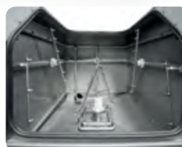
Conjunto de inyectores distribuido para alcanzar todas las áreas de lavado. Set of nozzles distributed to reach all areas to be washed
