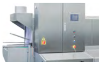
Cuadro eléctrico con PLC Electrical panel with PLC
