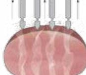
5/ Al salir las agujas, parte de la salmuera depositada en sus agujeros sale al exterior perdiendo parte de la inyección.
